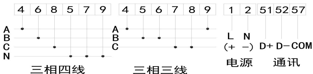
交直流辅助电源或带通讯的 09 外形电压表接线图
